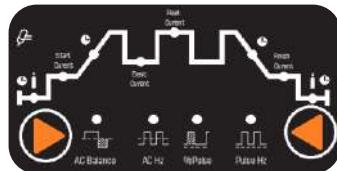
Щоб обрати потрібний параметр режиму зварювання, натискайте кнопки вибору параметру TIG зварювання (вліво, вправо). При цьому світлодіодний індикатор обраного параметра буде світитися на циклограмі TIG зварювання
