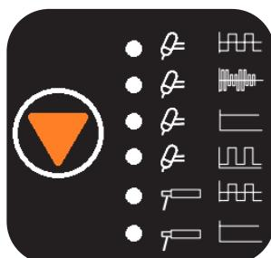
На панелі керування, за допомогою перемикача видів зварювання, оберіть функцію аргонодугового зварювання, вид струму та наявність пульсацій
