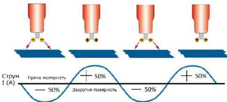
Після цього, не торкаючись соплом заготовки, тримайте пальник зі збереженням постійного зазору між електродом і заготовкою (блізько 2-3мм), для отримання стабільної зварювальної дуги. Змінний струм (AC) складається з півхвиль прямої і зворотної полярності. Струм зворотної полярності руйнує оксидну плівку на поверхні зварюваного металу, в той час як струм прямої полярності плавить його. На малюнку показано вихідне (діюче) значення зварювального струму.
