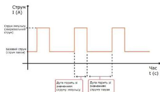
**Частота пульсаций** - кількість перемикань за секунду між значеннями зварювального струму, коли значення струму змінюється від струму імпульсу до струму паузи. Частота імпульсів при роботі на постійному струмі зазвичай становить 0,5-200 Гц, залежно від виду зварювальних робіт. Регулюванням цього параметра можна змінювати зовнішній вигляд зварювального шва.
