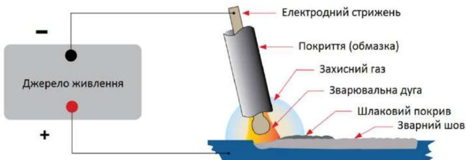
Металевий стержень електроду виготовляється з металу, який має такі самі або наближені фізичні та хімічні властивості з основним металом (заготовкою). Після зварювання та охолодження, шлак, що утворився від плавлення обмазки, видаляється механічним шляхом зі зварного шва.
