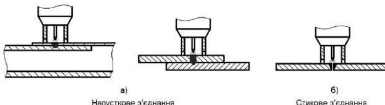
Для повноцінного використання режиму SPOT необхідно використовувати спеціальний пальник або SPOT-насадки, котрі одягаються на звичайний пальник аргонодугового зварювання (WP-18, WP-26 і т.д.) та забезпечують правильне позиціонування сопла і вольфрамового електроду відносно шва. Залежно від виду зварного з'єднання, використовують такі види насадок: насадка для напускового з'єднання, насадка для таврового з'єднання, насадка для кутового з'єднання та насадка для кільцевого з'єднання.
