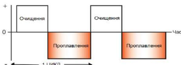
**Збільшуочи значення балансу полярності**, зварювальник збільшує тривалість півхвиль оберненої полярності: струм направлений від деталі, що зварюється до вольфрамовому електроду. Це сприяє більш інтенсивному руйнуванню оксидної плівки і очищенню поверхні деталі, що зварюється. При цьому тугоплавкий вольфрамовий електрод може почати руйнуватися (оплавлятися) від перегріву.
