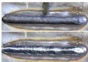
Плавно і рівномірно переміщуйте електрод уздовж поверхні деталей що зварюються, для переривання дуги, різко відведіть електрод від поверхні деталей.
