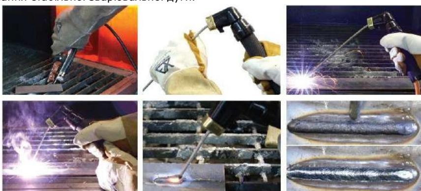
Плавно і рівномірно переміщуйте електрод уздовж поверхні деталей що зварюються, для переривання дуги, різко відведіть електрод від поверхні деталей.
