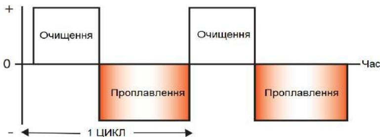
**Збільшуючи значення балансу полярності**, зварювальник збільшує тривалість півхвиль оберненої полярності: струм направлений від деталі, що зварюється до вольфрамовому електроду. Це сприяє більш інтенсивному руйнуванню оксидної плівки і очищенню поверхні деталі, що зварюється. При цьому тугоплавкий вольфрамовий електрод може почати руйнуватися (оплавлятися) від перегріву.
