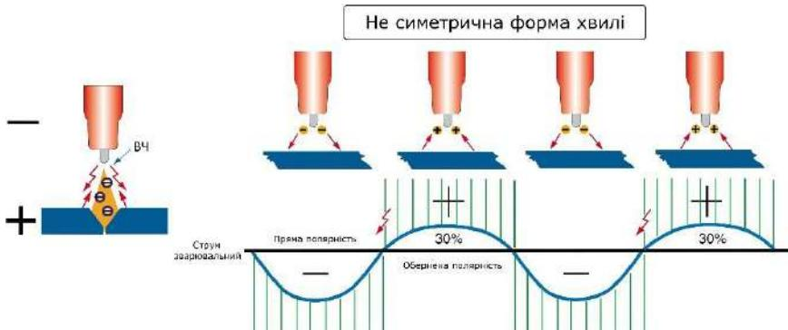
У момент переходу струму через нульове значення вже сформоване високе значення напруги дозволяє моментально запалити дугу. Дуга стабілізується без використання осцилятора (ВЧ), що працює в режимі стабілізатора горіння дуги.
