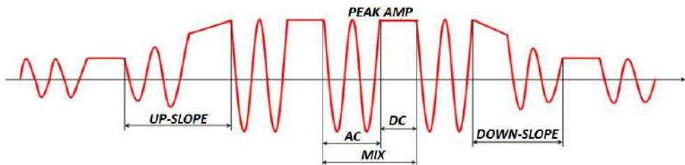
Режим MIX TIG – це чергування змінного (AC) і постійного (DC) струму під час зварювання. Змінний струм руйнує оксидну плівку на поверхні деталі, а постійний струм забезпечує велику глибину проплавлення. Таким чином досягається найкраща якість зварювання. Завдяки режиму MIX TIG глибина проплавлення може збільшуватися до 40%.
