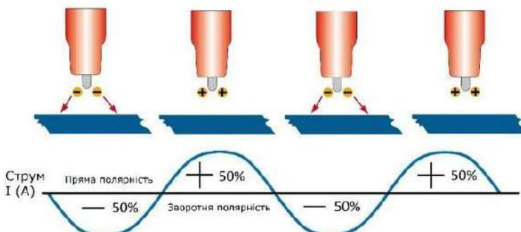
стабільної зварювальної дуги. Змінний струм (AC) складається з півхвиль прямої і зворотної полярності. Струм зворотної полярності руйнує оксидну плівку на поверхні зварюваного металу, в той час як струм прямої полярності плавить його. На малюнку показано вихідне (діюче) значення зварювального струму.
