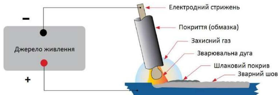
Покриття електроду виконує цілий ряд важливих функцій: утворення захисного газу навколо зони зварювання, забезпечення флюсуючими елементами та розкислювачами розплавленого металу, створення захисного шлакового покриття над зварним швом при його охолодженні, покращення дугових характеристик, введення легуючих елементів у метал шва.
