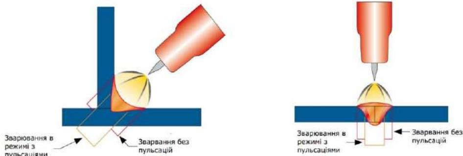
Приклад: значення коефіцієнту заповнення 80% при частоті проходження імпульсів 1 Гц означає, що дуга горить 0,8 секунди зі значенням струму імпульсу, а 0,2 секунди зі значенням струму паузи. Збільшення коефіцієнту заповнення призводить до збільшення тепловкладення. Використання режиму зварювання з пульсаціями на постійному струмі (DC TIG PULSE) дозволяє збільшити швидкість зварювання з кращим
