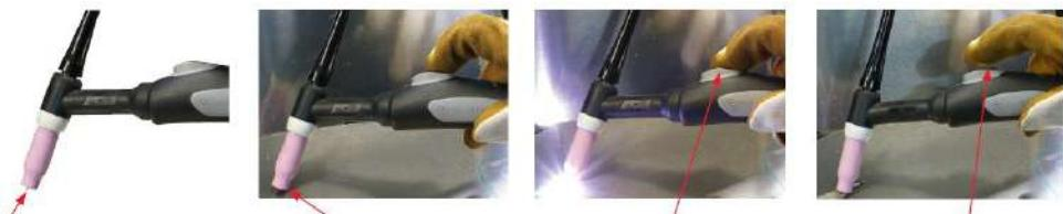
Тримайте пальник над деталлю, спершись на керамічне сопло під кутом, щоб забезпечити відстань 1-3 мм від електрода до заготовки. Натисніть на кнопку керування на пальнику і в проміжку між електродом та деталлю запалиться електрична дуга. Після цього, не торкаючись соплом заготовки, тримайте пальник зі збереженням постійного зазору між електродом і заготовкою (блізько 2-3мм), для отримання стабільної зварювальної дуги.
