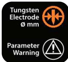
Виберіть діаметр електроду, яким ви плануєте виконувати зварювання. Якщо індикатор помилки «Parameter Warning» світиться жовтим кольором - це вказує на некоректний струм зварювання по відношенню до обраного діаметру електрода. Індикатор тільки попереджує про занадто низький чи високий зварювальний струм і жодним чином не обмежує функціональні можливості обладнання. Якщо індикатор помилки «Parameter Warning» не світиться - діаметр електроду і струм зварювання обрано правильно.
