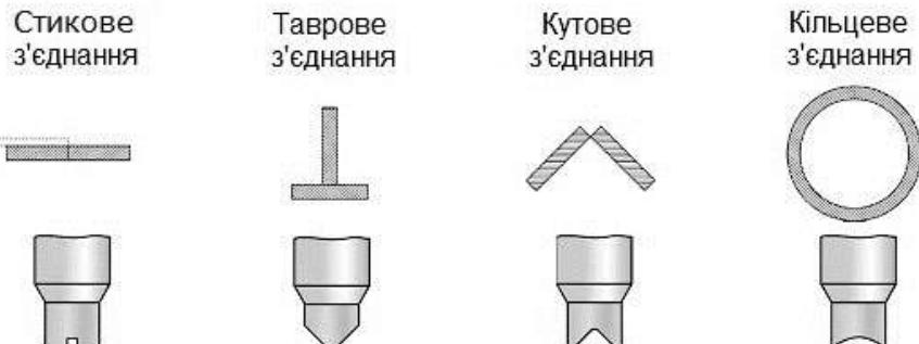
Під час зварювання, між пластинами що зварюються, не допускається попадання бруду, мастила, інших сторонніх предметів. Пластини повинні бути рівними та не деформованими. Даний апарат може виконувати зварювання листів металу від 0,5мм до 2,5мм з низько- і високолегованої, а також оцинкованої сталі.
