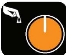
Щоб перейти до налаштування параметрів зварювання, оберіть відповідний параметр на циклограмі зварювання да допомогою натискання на регулятор (3). При цьому світлодіодний індикатор обраного параметра буде світитися. Щоб зміні значення обраного параметра, обертаєте регулятор за годинниковою стрілкою для збільшення його значення та проти годинникової стрілки для зменшення його значення.
