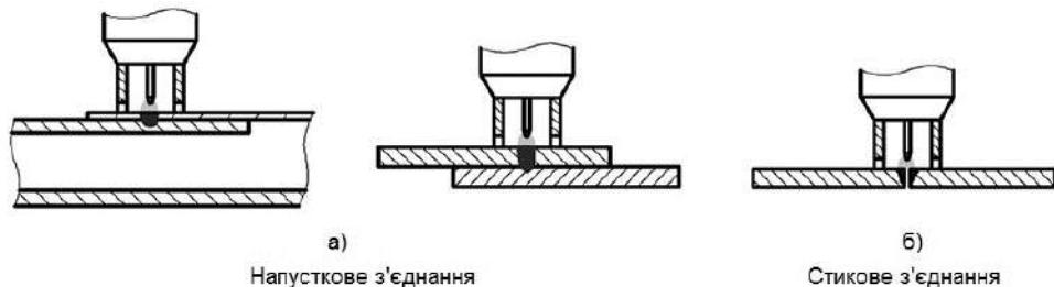
Для повноцінного використання режиму SPOT необхідно використовувати спеціальний пальник або SPOT-насадки, котрі одягаються на звичайний пальник аргонодугового зварювання (WP-18, WP-26 і т.д.) та забезпечують правильне позиціонування сопла і вольфрамового електроду відносно шва. Залежно від виду зварного з'єднання, використовують такі видів насадок: насадка для стикового з'єднання, насадка для таврового з'єднання, насадка для кутового з'єднання та насадка для кільцевого з'єднання.
