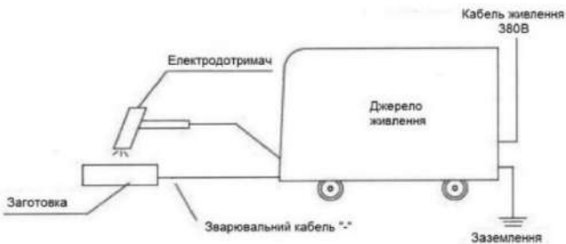
МОНТАЖ ОБЛАДНАННЯ ДЛЯ ММА ЗВАРЮВАННЯ
