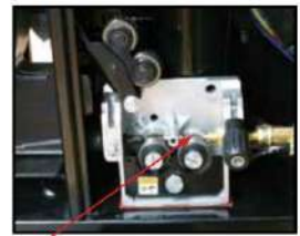
Подайте електродний дрід на привідний ролик таким чином, щоб дрід виходив за межі випускного отвору на 150-200мм. Зафіксуйте дрід проковзним роликом.
