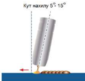
Відмінне формування шва, гарний контроль зварювання
