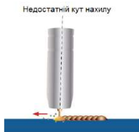
Збільшене розбризкування металу, погіршений контроль зварювання
