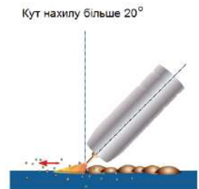
Велике розбризкування, поганий контроль зварювання та погане проплавлення, нестабільна дуга
