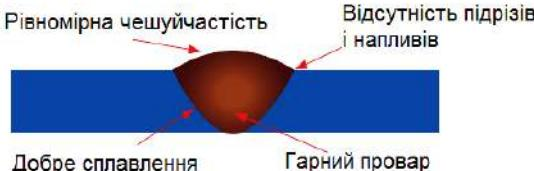
Швидкість переміщення може змінюватися в залежності від умов зварювання та кваліфікації зварника, вона обмежується здатністю зварника контролювати зварювальну ванну. Швидкість переміщення повинна відповідати величині струму зварювання, товщині та виду заготовки, технологічним вимогам до зварного шва.
