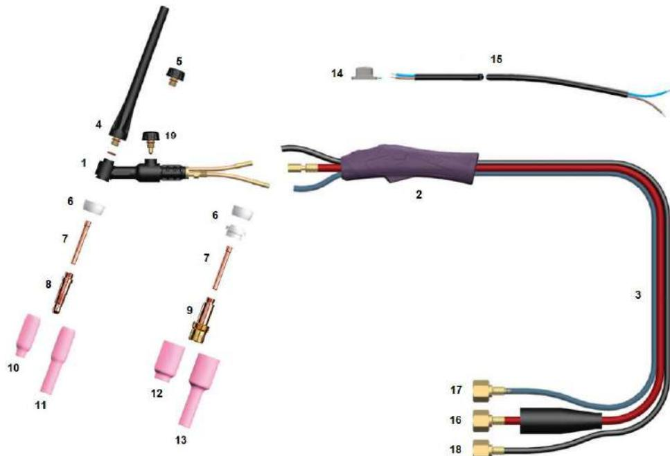
**Конструкція вентильного TIG пальника з рідинним охолодженням\***
