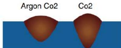
При напівавтоматичному зварюванні нержавіючих сталей використовують два види сумішей:
