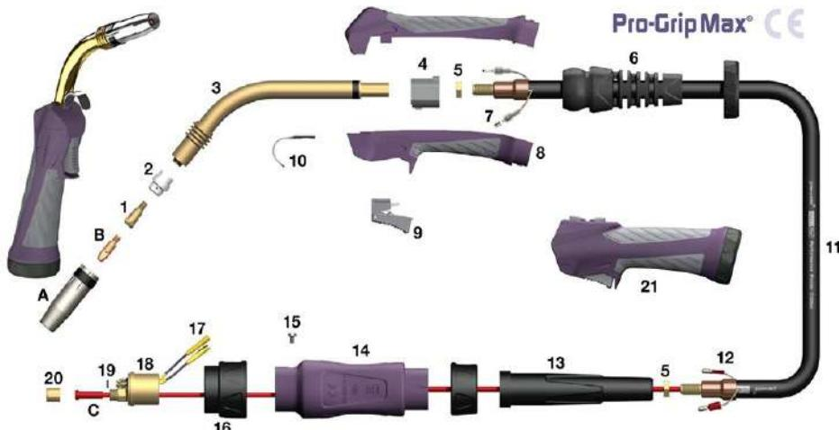
Зварювальний MIG/MAG пальник складається з трьох основних вузлів: центральний роз'єм KZ-2 для підключення до зварювального апарату; шланговий пакет, який містить у собі дроти керування, силовий кабель, направляючу спіраль електродного дроту та шланг для підведення газового захисту; робоча частина пальника. Зазвичай шланговий пакет для напівавтомату має довжину від 2,5 до 5 метрів.
