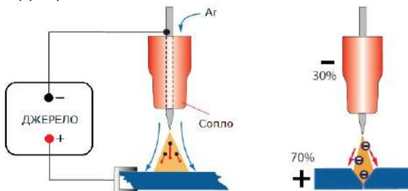
**TIG зварювання даним апаратом можливе лише при використанні спеціального TIG-пальника вентильного типу**, який дозволяє зварнику самостійно контролювати подачу і витрату захисного газу.
