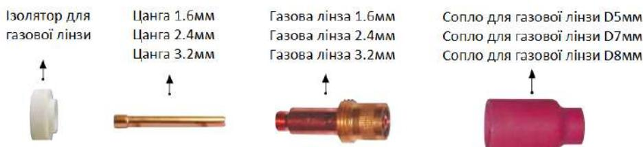
**Використання корпусу цанги з газовою лінзою** (газова лінза) сприяє підвищенню надійності газового захисту зони зварювання. При використанні пальника без газової лінзи, швидкість газового потоку є змінною (потік турбулентний), у зв'язку з чим виникає зона розрідження у соплі пальника, через яку у зварний шов може потрапляти кисень та водень з атмосфери.
