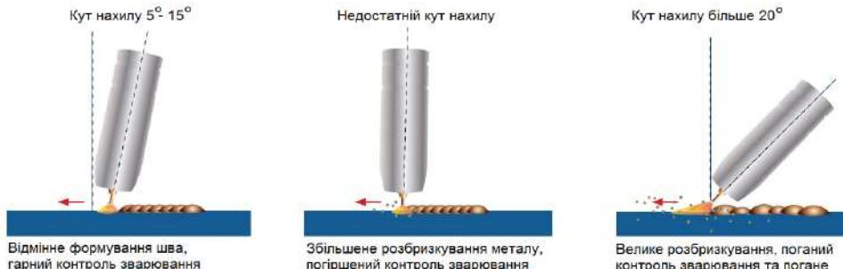
**Кут нахилу пальника** від 5° до 15° ідеально підходить для зварювання і забезпечує хороший рівень контролю над зварювальною ванною. Кут нахилу більший, ніж 20°, призведе до нестабільного горіння дуги, поганого перенесення металу, меншої глибини проплавлення, а також, великого розбризкування.
