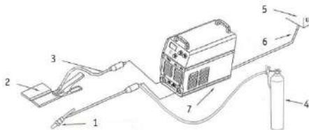
**Підключіть кабель живлення до електричної мережі** з необхідними параметрами згідно ДСТУ EN 50160:2014 і ГОСТ 13109-97. Перевірте надійність підключення кабелю живлення. **ЗАБОРОНЯЄТЬСЯ** використання робочих кабелів завдовжки більше ніж 5 метрів. Для підключення обладнання до віддалених мережевих роз'ємів використовуйте відповідні подовжуваачі.
