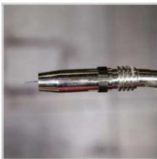
**Виліт електродного дроту** - довжина нерозплавленого дроту, що виступає з кінця контактного наконечника. Значення виліту електроду в межах 5-10мм, забезпечує стійке горіння дуги, відмінне проплавлення металу та формування шва. Занадто малий виліт - приведе до нестабільного горіння дуги, перегріву контактного наконечника. Занадто великий виліт – велике розбризкування металу, нестабільність горіння дуги, погане проплавлення.
