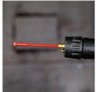
6. Змонтуйте на шийці пальника вставку, зварювальний наконечник та газове сопло (\*в залежності від типу пальника);
