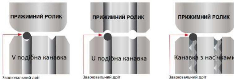
Ролики з двома канавками маркуються з обох боків в залежності від того, який діаметр дроту використовується. При встановленні ролика з двома канавками до механізму, слід пам'ятати, що робочою є та канавка, що розташована ближче до двигуна. Якщо ролик встановлений неправильно, то порушується стабільність подавання дроту і виникає велика вірогідність того, що зварювальний процес буде не стабільний.
