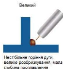
**Виліт електродного дроту** - довжина нерозплавленого дроту, що виступає з кінця контактного наконечника. Значення вильоту електроду в межах 5-10мм, забезпечує стійке горіння дуги, відмінне проплавлення металу та формування шва. Занадто малий виліт - призведе до нестабільного горіння дуги, перегріву контактного наконечника. Занадто довгий виліт - велике розбризкування металу, нестабільність горіння дуги, погане проплавлення.
