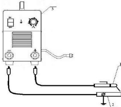
1 - Електродотримач; 2 - Заготовка; 3 - Зварювальний апарат
