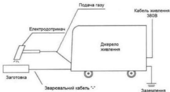
МОНТАЖ ОБЛАДНАННЯ ДЛЯ ДУГОВОГО СТРУГАННЯ
