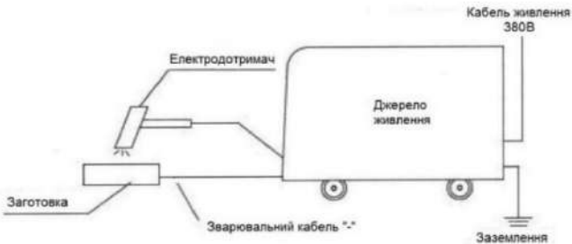
МОНТАЖ ОБЛАДНАННЯ ДЛЯ ММА ЗВАРЮВАННЯ
